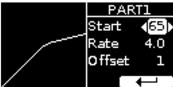
Esempio di compressione della curva di dinamica
